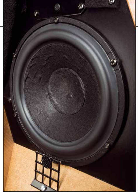
Ein hochwertiger Tiefmitteltöner aus dem Hause Scan Speak sitzt hinter der Frontbespannung
