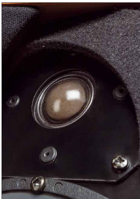
Die schräg abstrahlende Hochtonkalotte ist für die spezielle Einbausituation angepasst
